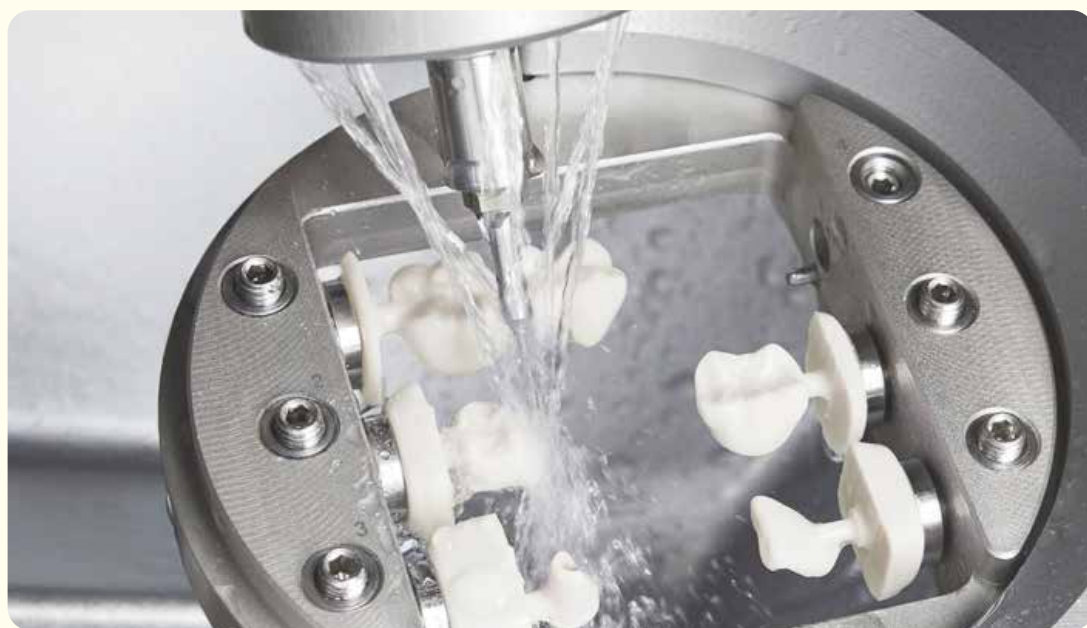
CAD/CAM冠 削りだし加工の様子( https://www.vhf.com/ )
